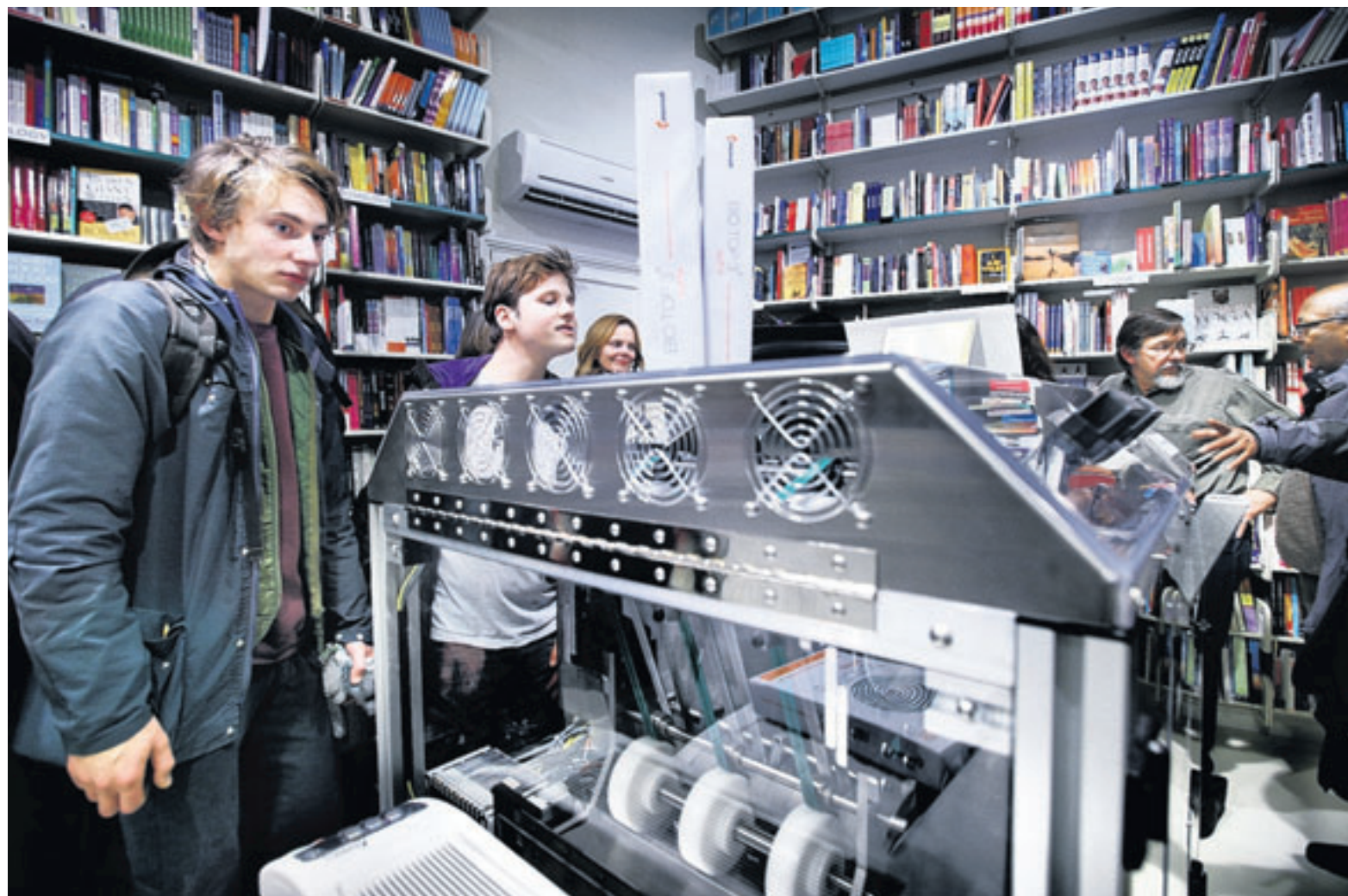
De Espresso Book Machine van het American Book Center drukt dertig pagina's per minuut. Hij bindt en lijmt het boek ook.
